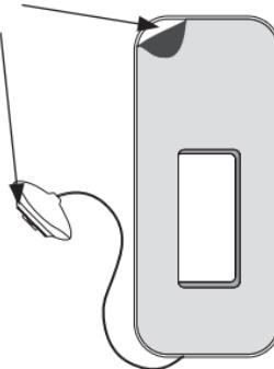
Retira la capa protectora sobre la cinta doble cara **del sensor (H)**. Coloca el sensor en el suelo, donde es más probable que se produzcan fugas.
