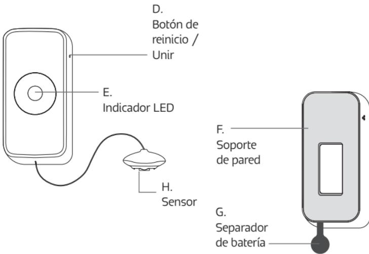
1. Presione y desliza la tapa trasera **del sensor (A)** para exponer la batería. Retira **el aislador de la batería (G)** tirando del plástico. Vuelve a colocar la tapa trasera
