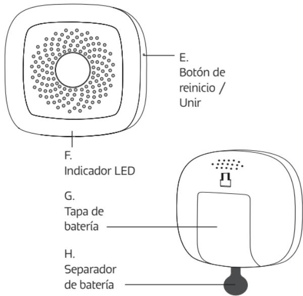
1. Retira el soporte de pared (**D**) y la tapa de la batería (**G**). A continuación, retira el aislante de la batería (**H**) tirando del plástico. Vuelve a colocar la tapa trasera.
